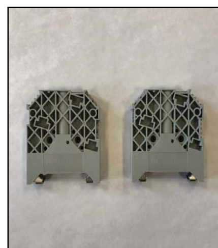
Концевые анкера 1492-EANJ35: (не входя в комплект поставки) предназначены для закрепления контроллера 5069 на DIN-рейке. Требуется 2 шт.
