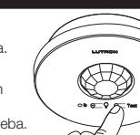
**NOTA:** Despues de colocar la batería, sigue un período de calentamiento de 90 segundos antes de la activación del modo de prueba. Si se presiona el botón durante este período, el lente parpadeará continuamente hasta que finalice el período de calentamiento y luego se ingresará automáticamente al modo de prueba.
